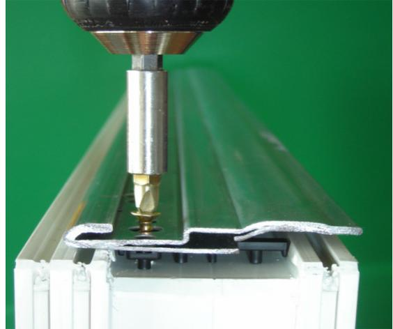
Spezialverstärkungseisen mit Blendrahmen verschrauben
