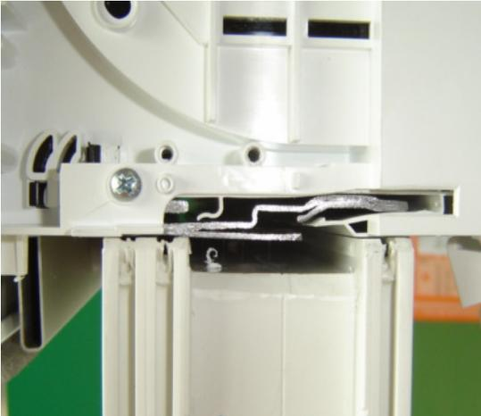
Aufsatzkasten auf das Spezialprofil aufschieben
